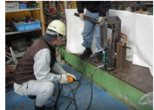
2018年度事業 「油圧を用いた鋼管の無火気切断装置の試作」
